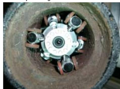
Für die Betrachtung von Korrosionsschäden, Verschmutzungen oder Materialfehlern sollte ein Videokopf mit Direktsicht und eine Superweitwinkeloptik verwendet werden. Je nach Bauart und Größe des CRAB-ROBOT können unterschiedliche Videoköpfe verwendet werden. (siehe Tabelle)
