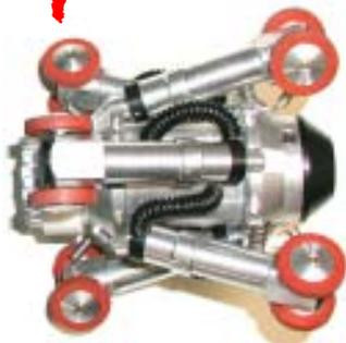
Die Steuerleitungen sind in einem flexiblen Schutzschlauch gegen Beschädigungen gekapselt und gleiten somit problemlos durch enge Rohrbögen.
